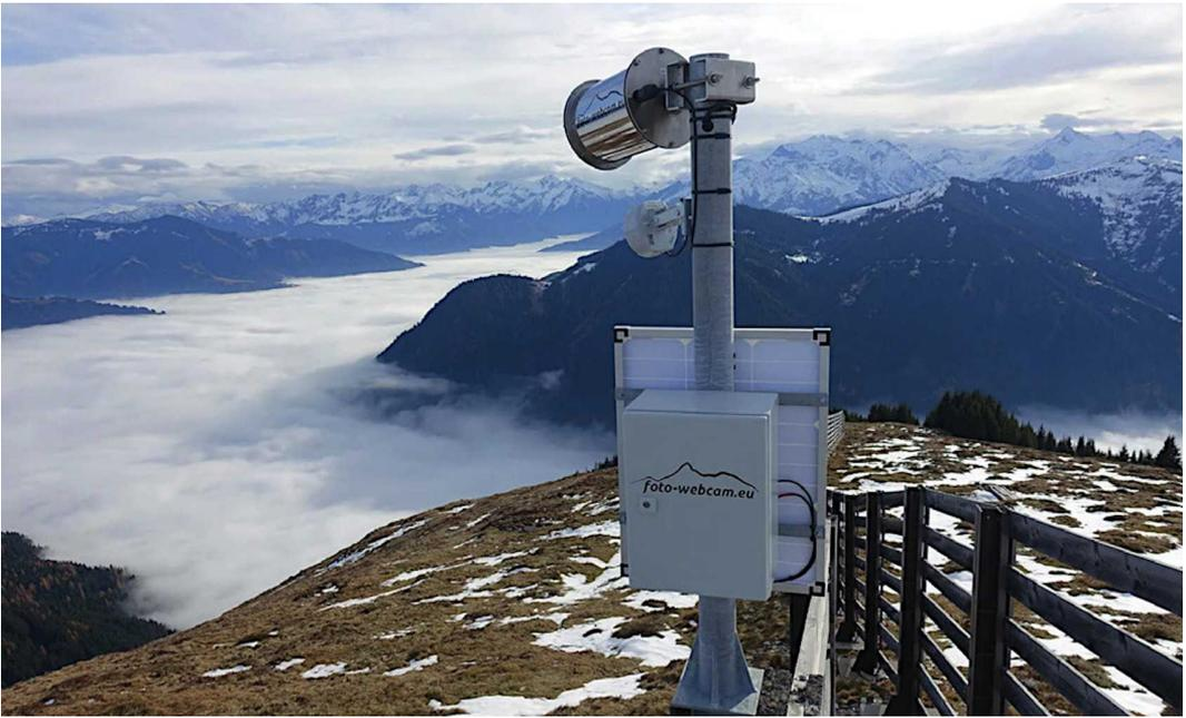
Abb. 6.2: Installation einer Webcam im wetterfesten Gehäuse an der Station Maishofen/Sausteige.
